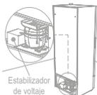
El artefacto tiene un estabilizador de voltaje para evitar daños en su equipo por variaciones de corriente. Una vez conectado el artefacto verificar por la parte frontal que el mismo esté encendido. El estabilizador tiene un tiempo de retardo de 5 minutos para nivelar las fluctuaciones de energía de la red y energizar el artefacto.
