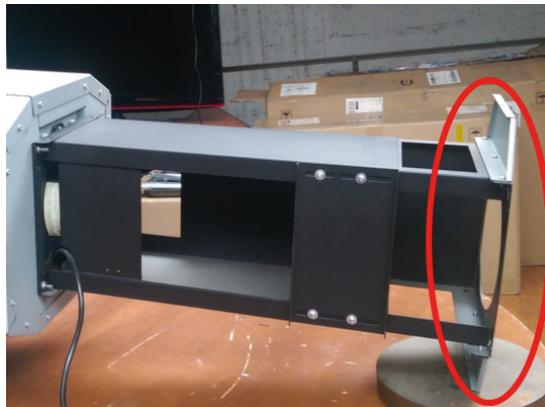
**Nota:** La única parte que pueden fijar o soldar es la parte de la estructura superior lo que está marcado con rojo para los 4 pernos de sujeción, mas no la chimenea decorativa. De ser posible no se recomienda soldar ya que si realizan una estructura para soportar la campana es preferible dejarla con pernos para poder extraerlos fácilmente en caso de requerir atenciones para servicio técnico.
