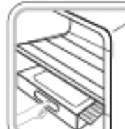
El agua proveniente del descongelamiento se depositará en la bandeja de descongelamiento situada en la parte inferior del evaporador. Vacíe y limpie la bandeja.
