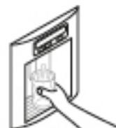
Dispositivo para proveer agua fría al exterior del refrigerador, sin necesidad de abrir la puerta.
