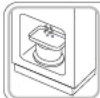
El agua proveniente del descongelamiento automático se depositará en la bandeja situada en la parte posterior sobre el compresor, evaporándose por el calor que este proporciona.
