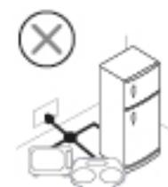
No use extensiones ni adaptadores múltiples que compartan otros artefactos, debido a que ocasionan pérdidas de voltaje y recalentamiento de cables.
