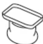
Se debe limpiar periódicamente la bandeja de descongelamiento que se encuentra sobre el compresor, en la parte posterior del refrigerador.
