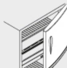
El calentamiento del divisor central metálico es normal para evitar condensación de agua.
