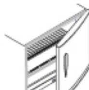
El calor que usted siente en la periferia de su refrigerador es **NORMAL**, debido a que nuestros refrigeradores utilizan el moderno sistema **HOT WALL**, que evita la condensación mediante el tubo de calentamiento por el que circula el calor del gas refrigerante sin consumir energía.
