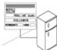
Asegúrese de verificar que el voltaje y frecuencia del lugar dónde se va a instalar éste refrigerador sea el indicado en la placa de identificación que se encuentra en la parte posterior de su refrigerador.
