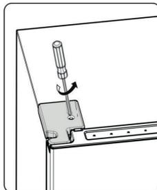
2. Desconecte el terminal y retire la cubierta de la bisagra superior.
